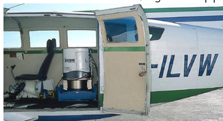
รูปที่ ๓ การติดตั้งกล้องถ่ายภาพทางอากาศเชิงเลข (Digital Mapping Cameras)
