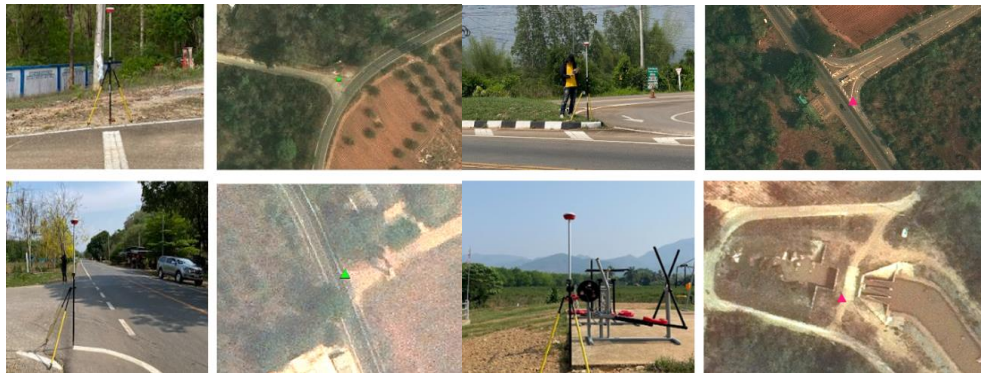
รูปที่ ๙ แสดงตัวอย่างการรังวัดหมุด GCP และ Check Point จากภาคสนาม
