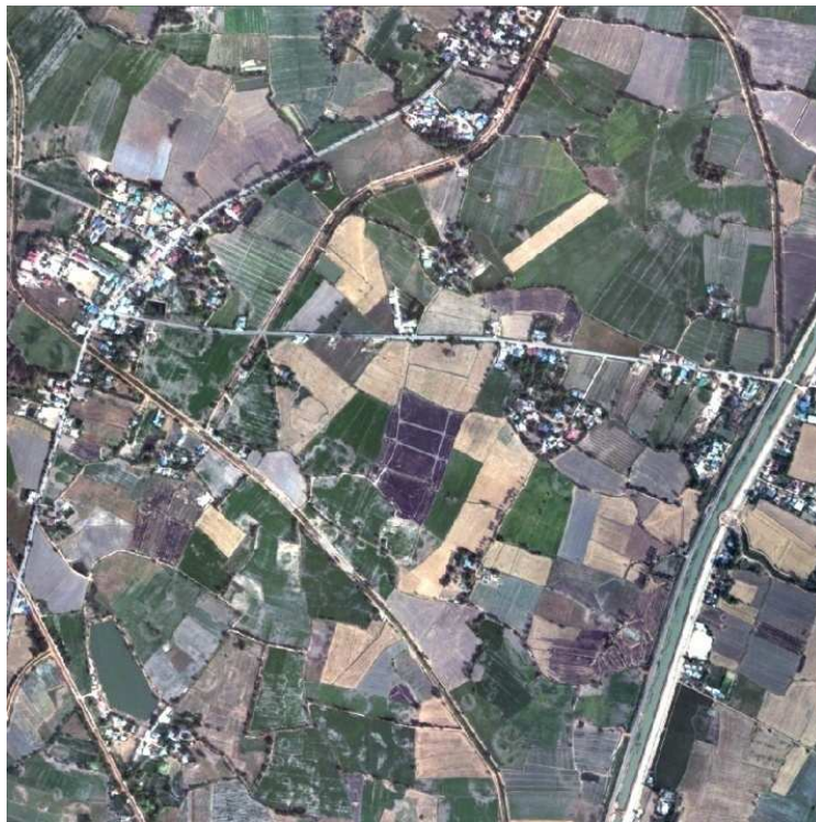
ภาพที่ ๓ ตัวอย่างระวางแผนที่รูปถ่ายทางอากาศเชิงเลข (DMC) มาตรฐาน ๑:๔,๐๐๐
