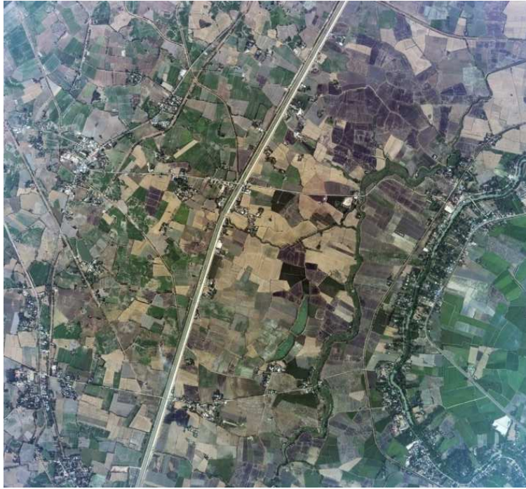
ภาพที่ ๒ ตัวอย่างภาพถ่ายทางอากาศสีเชิงเลข GSD ๔๘ เซนติเมตร
